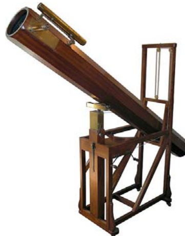
Nahoře dalekohled Gregoryho typu od Jamese Shorta z roku 1769 o průměru 11 cm a ohnisku 60 cm. Dole replika dalekohledu Williama Herschela, kterým v roce 1781 objevil planetu Uran. Dalekohled má průměr 15 cm a délku 210 cm. Způsob jeho uchycení a pohyb za oblohou je velmi komplikovaný.
