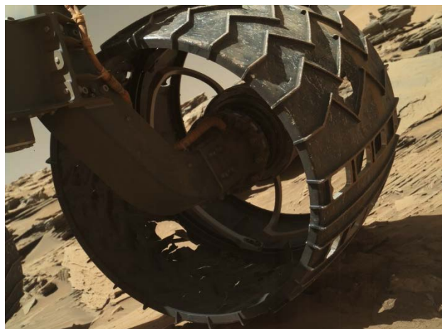
Proděravělé kolo Curiosity. Testy na Zemi dávají naději, že by se kola dala používat ještě jen s 60% původního povrchu.
