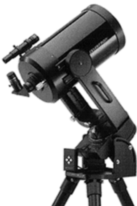
Katadioptrický Schmidt-Cassegrain Celestron 8 na vidlicové montáži.
