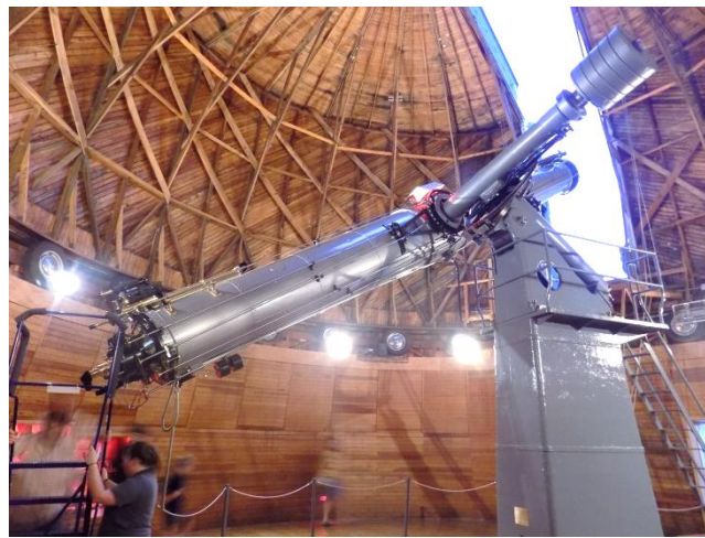
Clarkův refraktor s objektivem o průměru 61 cm a ohniskem 975 cm. Refraktor byl rekonstruován před dvěma roky.
