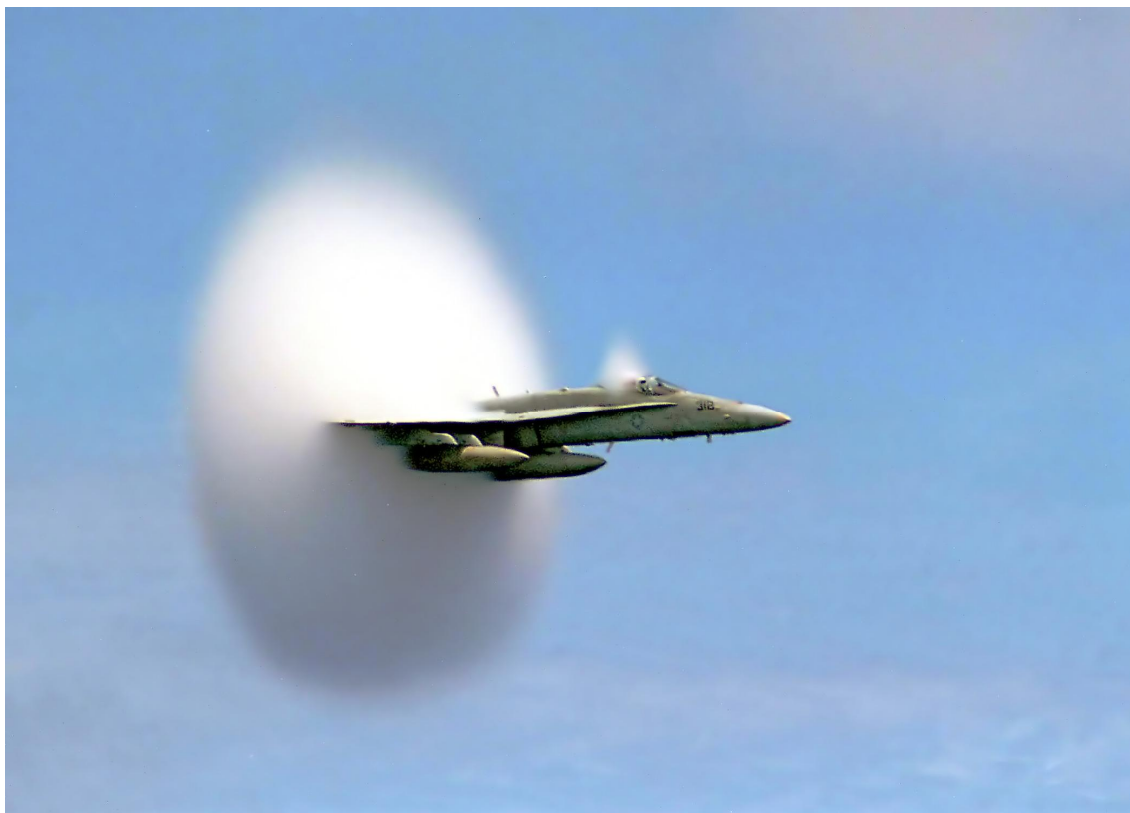
Obr. 11 – Letadlo F/A-18 letící nadzvukovou rychlostí. Bílá sférická clona je tvořena kondenzovanými kapičkami vody vzniklými náhlým poklesem tlaku a teploty za čelem rázové vlny u letadla [44,45].
